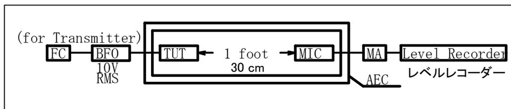
FC : 周波数カウンタ Frequency Counter      MA : メインアンプ Measuring Amplifier
